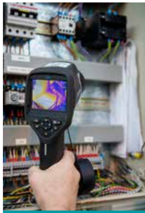
Doormeten van hoofd- en onderverdeelinrichtingen met warmtebeeldcamera.
